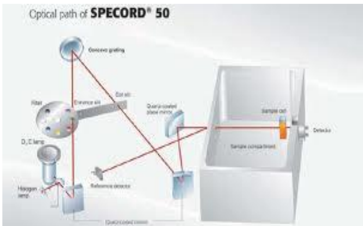
3-rasim. Specord – 50 spektrofotometrini tuzulishi:
