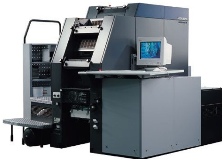
4-rasm. Heidelberg firmasining DI QM 46-4 raqamli bosma uskunasi.
