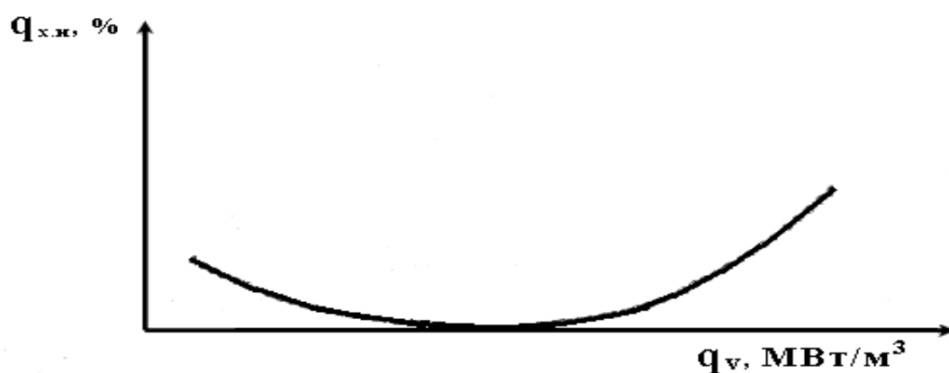
2.5-расм. Химиявий тўлиқ ёнмаслик туфайли иссиқлик йўқотилишларнинг иссиқлик чиқариш ҳажмий зичлигига боғлиқлик графиги
