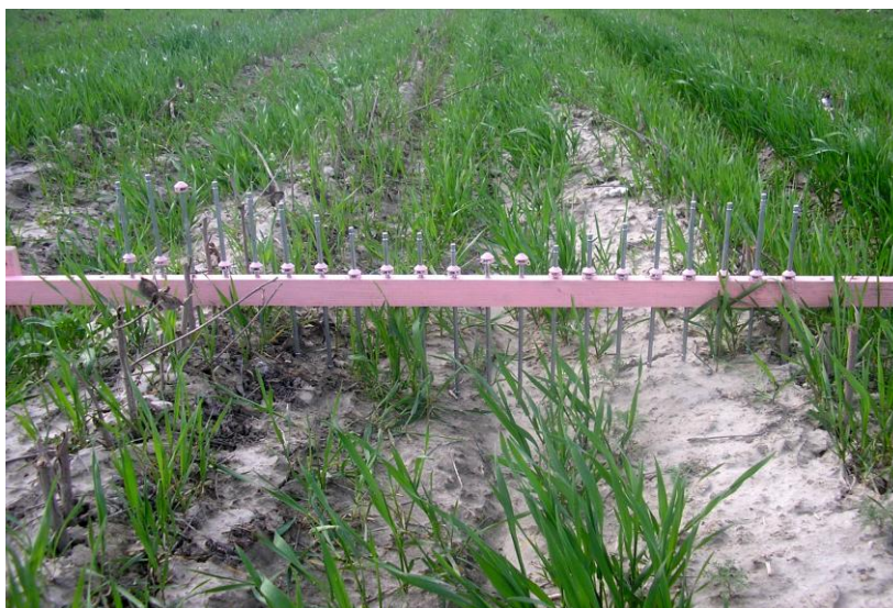
3.7-расм. Қатор ораси рельефини аниқловчи профиломер
