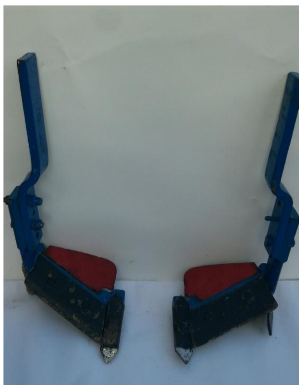
5-расм. Лойиҳаланган эгик тутқичли ишчи органнинг умумий кўриниши.
