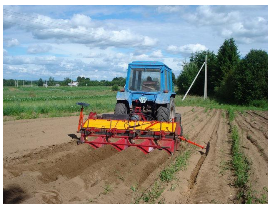
1.4-расм. МТЗ-80ХА маркали трактор ёрдамида пушта олиш.
