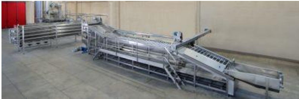
Mod.LONG-RUN 20 Группа промывки: сортировка, измелчитель, насос (увеличить)
