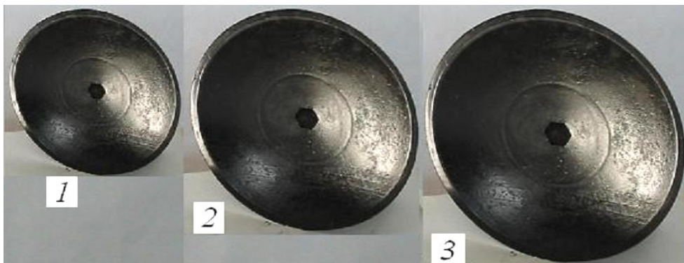
11-расм. Диаметри 450 (1), 550 (2) ва 650 (3) мм бўлган сферик дисклар
