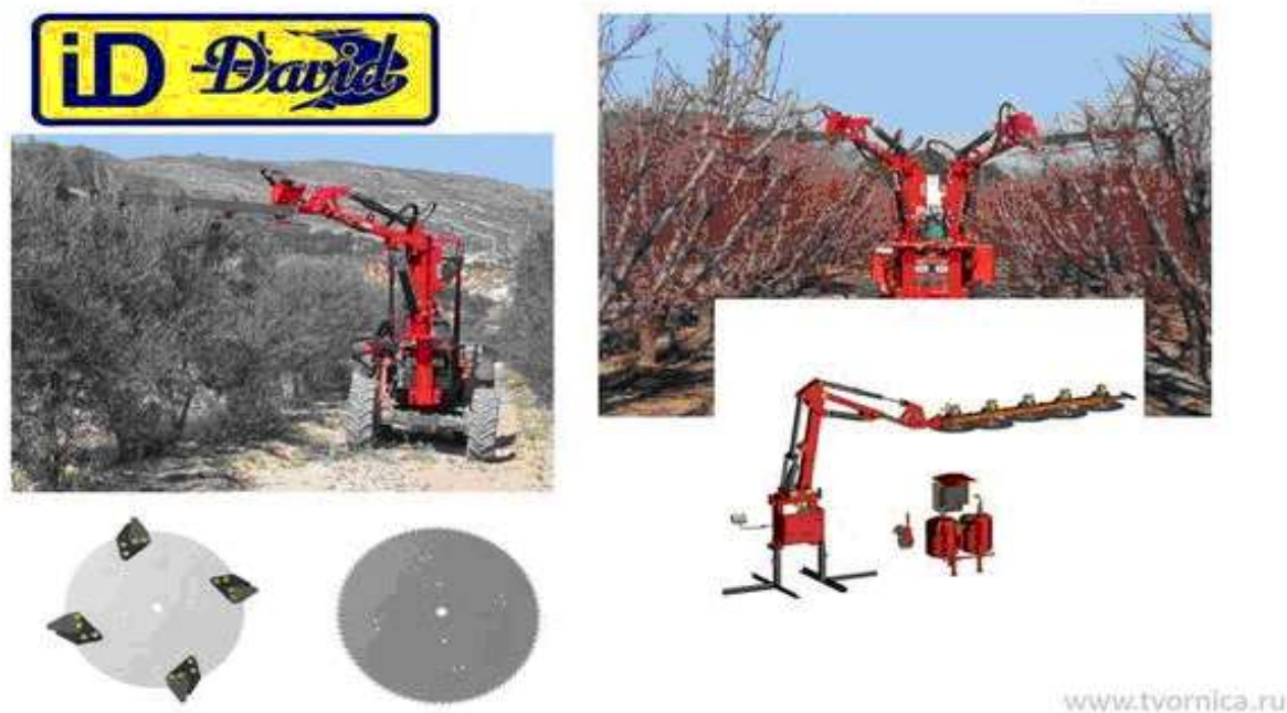
4-расм.Мева дарахтларига шакл берувчи замонавий машина
