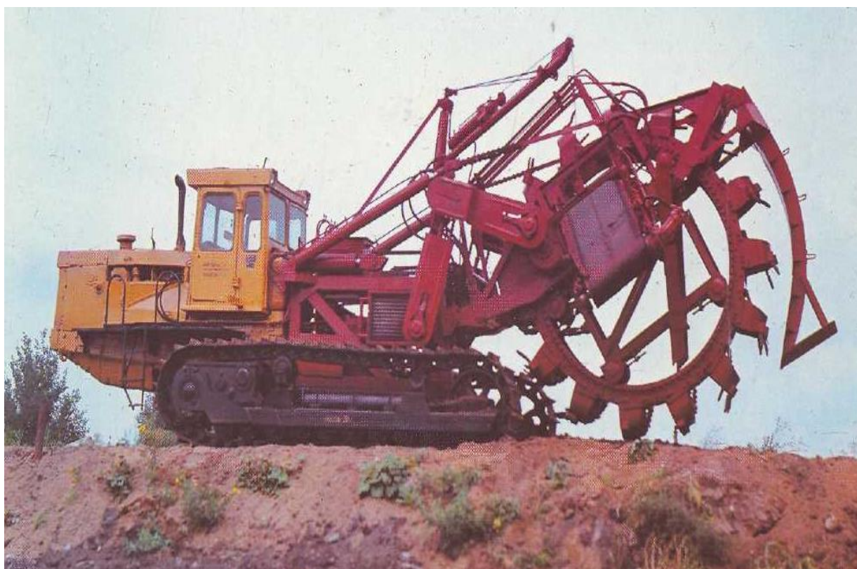
1-rasm.ETR – 224 A rotorli xandak qazish ekskavatori
