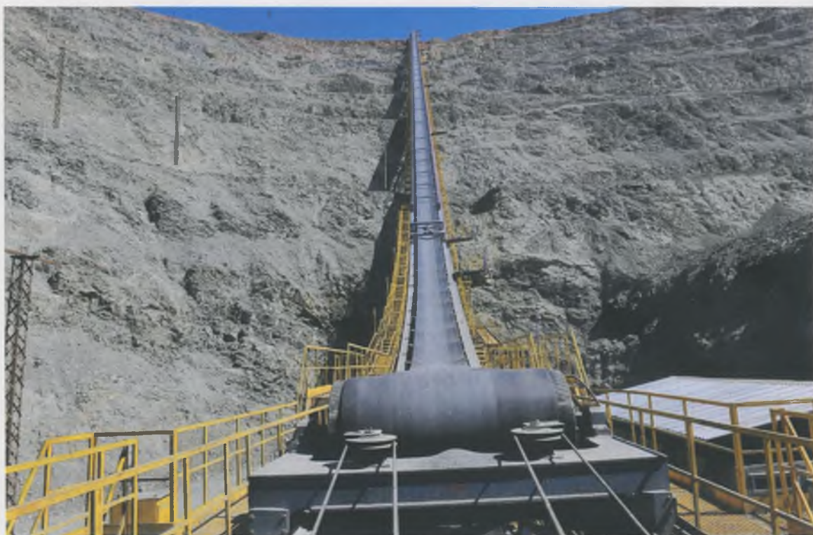
Мурунгов конидаги тик қия конвейринг олд кўриниши
