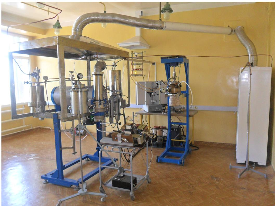
**Рис.1.4. Экспериментальная установка для реализации процесса синтеза моносилана**
