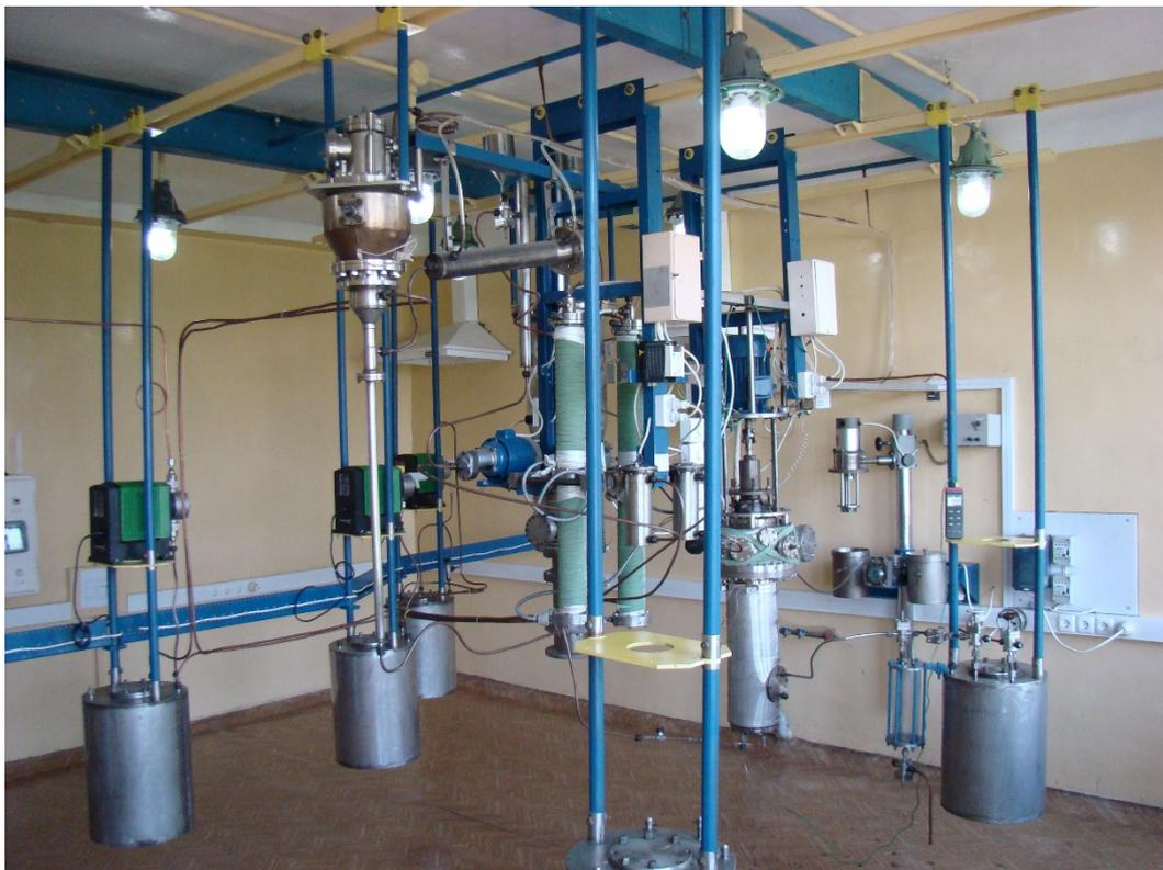
**Рис. 1.2. Общий вид экспериментальной установки для осуществления процесса синтеза алкоксисиланов**
