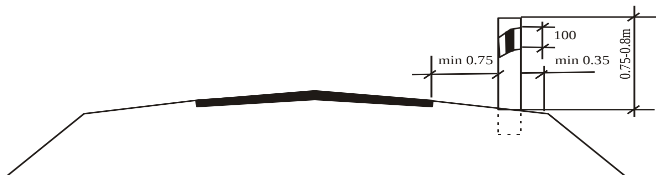
90-rasm. Yo'naltiruvchi ustunchalarni yo'lni ko'ndalang kesimida o'rnatish
