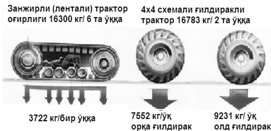
1.9-расм. Трактор юриш қисмининг тупроқнинг чуқурзичланишига таъсири
