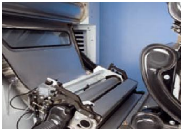
27-su'wret. To'liq integrallang'an hawa bo'listiriwshi segment lotokli DIRECTFEED ta'minlewshi menen birge pilte tegisligin jaqsilap g'ana qoymay, mashinani bir normada turaqli ta'minleydi. Bul da mashinanin' abzalliqclarinan bolip tabiladi.
