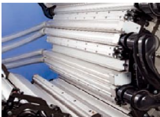
30-su'wret. MULTI WEBCLEAN barliq islew sharayatlari ushin maslasiwshan' ha'm mashinag'a qizmet ko'rsetiwdi jen'illestiredi ja'nede pilte sapasinin jaqsilaydi.
