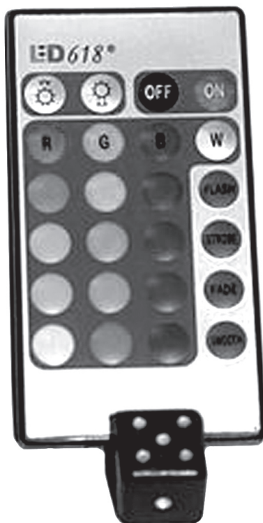
Рис. 14. Пульт дистанционного управления многофункционального трёхканального светодиодного диммера
