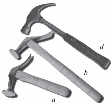
85-rasm. Poyabzal bolg'achalari: a — tanavorni tikish; b — taxta bolg'acha; d — etikdo'zlik bolg'achasi
