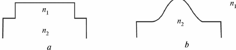
7.18-rasm. Pog'onali ( a ) va gradiyent ( b ) ko'p modali optik tolalarning tuzilishi va sindirish ko'rsatkichi ko'rinishlari.
