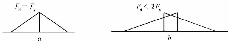
4.4-rasm: a — f_d=2F_y holatga mos keluvchi spektral diagrammasi; b — f_d<2F_y birlamchi signal spektri va past yon chastotalar spektri bir-birini berkitadi.
