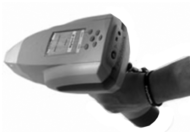
13-rasm. «PHAZIR™» portlovchi moddalar bug‘larining analizatori.
