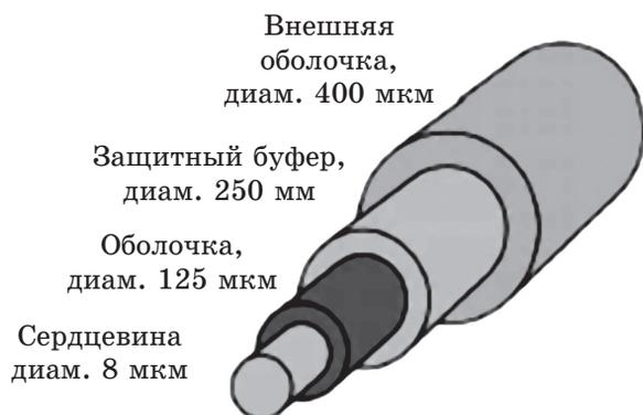
*Рис. 61.* Конструкция одномодового оптического волокна
