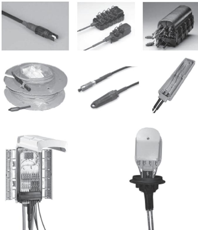
*Рис. 57.* Коннекторы, устанавливаемые как внутри, так и снаружи помещений. Первая строка: полностью герметичные коннекторы и устройства коммутации. Вторая строка: кабельные сборки с прединсталлированными коннекторами в герметичных минимухтах. Третья строка: герметичные муфты с установленными стандартными коннекторами
