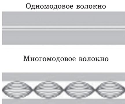
*Рис. 62.* Распространение светового луча в волокне
