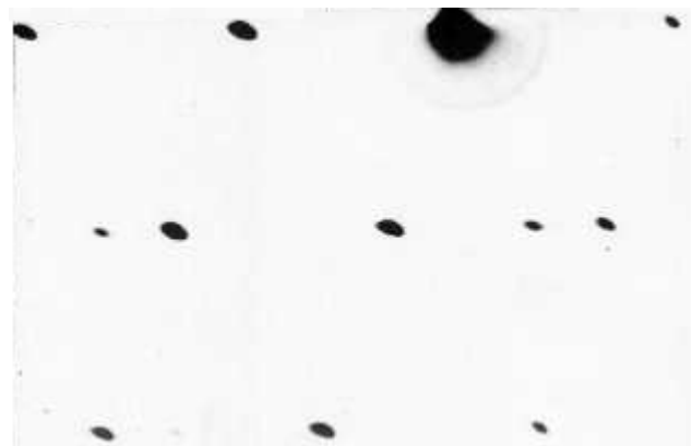
22-su'wret. Polisintetikali'q ZnSe kristalli'ni'n' (110) kristallografiyali'q tegisligine parallel bolg'an folgadan ali'ng'an elektronogramma.
