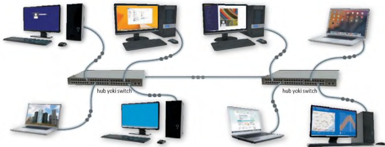
Rasm 10-18 Markaz (hub) yoki o'chirib yoqish (switch) lar soddalashtirilgan diagrammada tasvirlanganidek, bir qancha qurilmalarni va boshqa tarmoqlarni ham tarmoqda bog'laydi.
