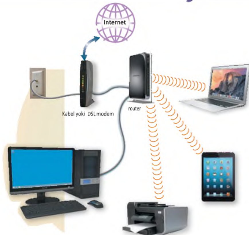
Rasm 10-15 router orqali, uy yoki biznes tarmoqlari kabel hamda DSL modemlar kabi keng internet xizmati aloqalariga kirish huquqini ulashishlari mumkin.
