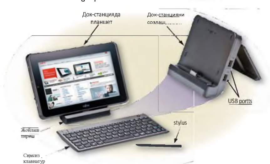
3-26 Rasm: Dok-stansiyalar odatda pereferik qurilmalar bilan aloqa o'rnatishni ta'minlaydi.
