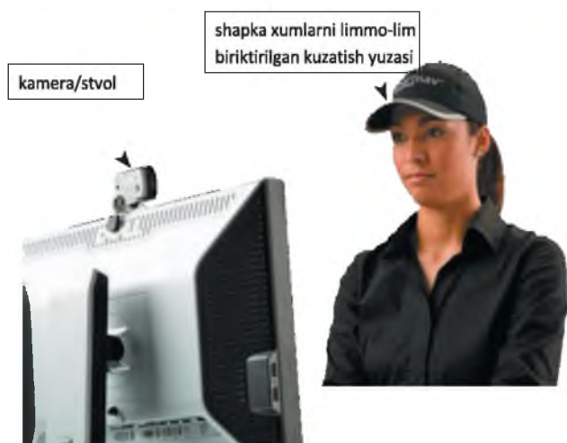
Figure 7-44 Kamera / qabul qilish monitor o'rnatilgan raqamli shapka xumlarni limmo-lim haqida o'ychan material boshga kiyilgan ko'rsatgichlar o'rnini izlaydi. Foydalanuvchi boshini aylantirsa ekrandagi ko'rsatkich ham harakat qiladi.
