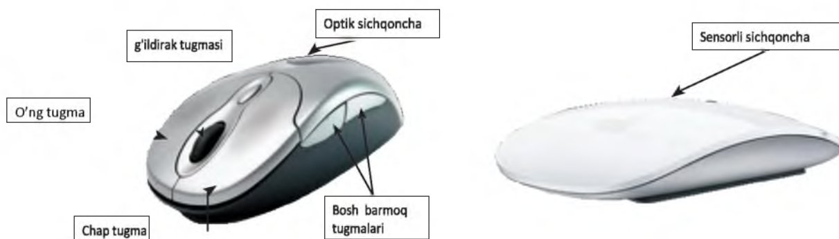
7-5-rasm. Optik sichqonchada tugmalar bor. Sensorli sichqonchalarda ba'zan tugmalar bo'lmaydi.
