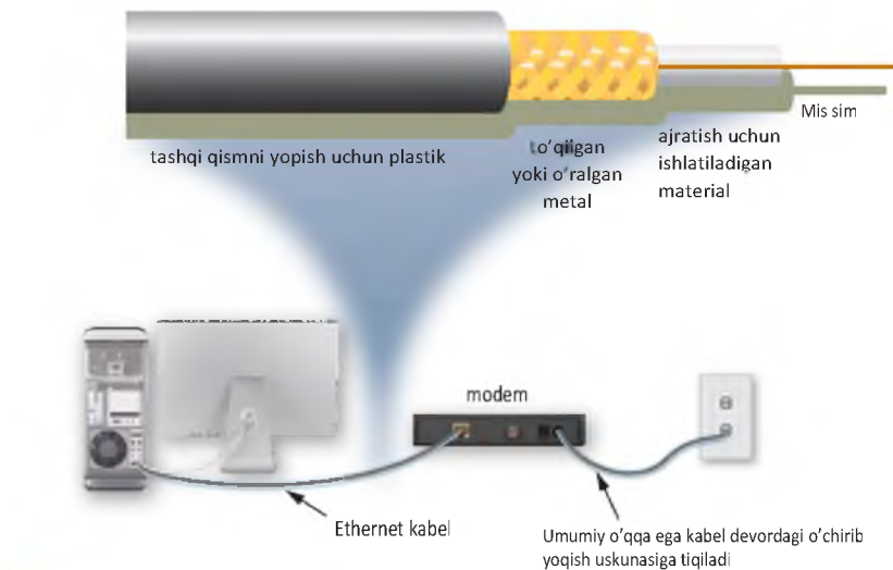
Rasm 10-21 Umumiy o'qqa ega kabelda ma'lumotlar mis sim bo'ylab aylanadi. Ushbu soddalashtirilgan suratda kompyuter modemga hamda, umumiy o'qqa ega kabel orqali CATV tarmog'iga ulangani ko'rsatilgan.
