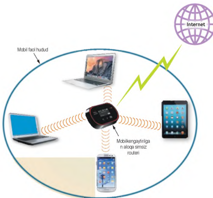
Chizma 10-16 mobil kengaytirilgan aloqa simsiz routeri foydalanuvchilarga internetdan 3G va 4G internet xizmatidan foydalanish imkonini yaratdi.
