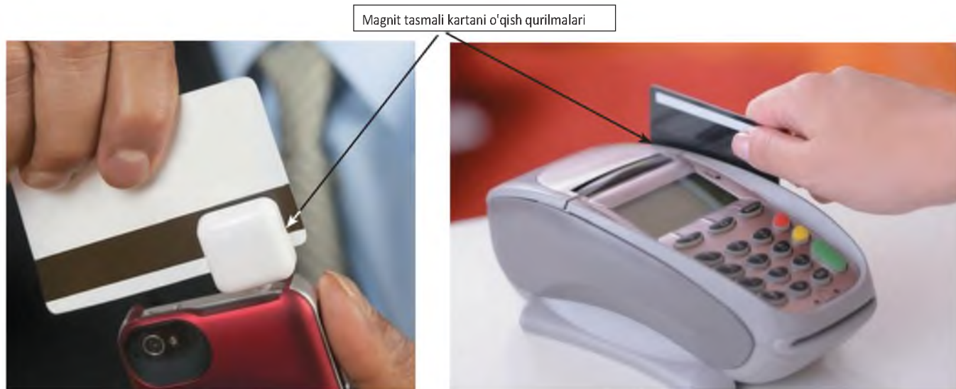
Rasm 7-20. Magnit tasmali o'quvchi qurilma kredit kartasi orqasidagi Karta polasasi ustida kodlangan ma'lumotlarni o'qiydi.
