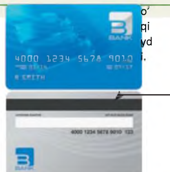
8-22-Rasm. kredit kartalari va boshqa ID kartalari orqasidagi magnit qatori sizni va kartangiz haqidagi ma'lumotlarni o'z ichiga oladi.
