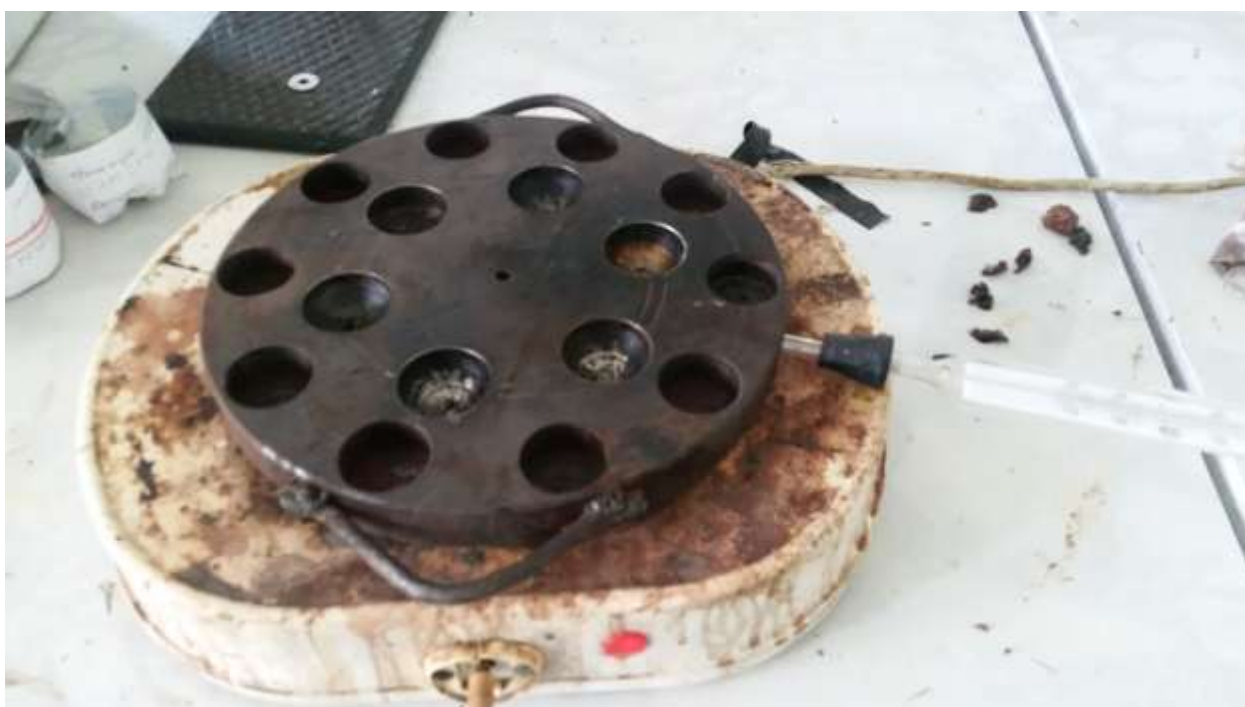
8-rasm. Fenolspirt va poliefirpolioldan sintez qilingan oligomerning qotish tezligini aniqlash jarayoni.
