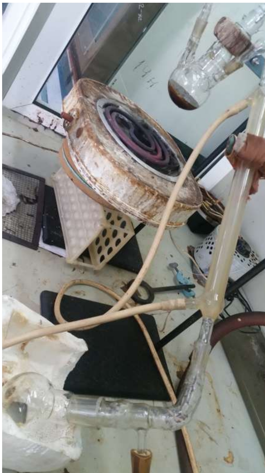
6-rasm. Fenolospirt va poliefirpolidan sintez qilingan oligomerdan vakuumda suvni ajratib olish jarayoni.
