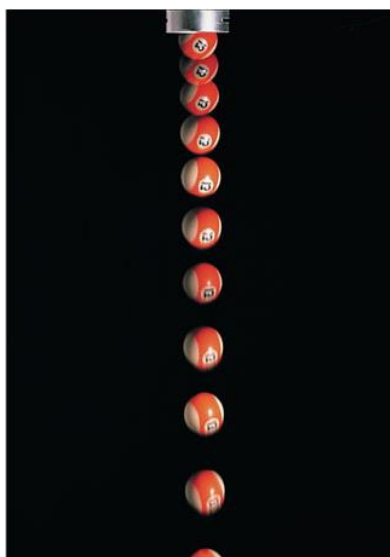
Teńdey waqıt aralıqlarında túsirilgen shardıń erkin túsiwi. Ótilgen joldıń shaması waqıttıń kvadartına proporcional.
