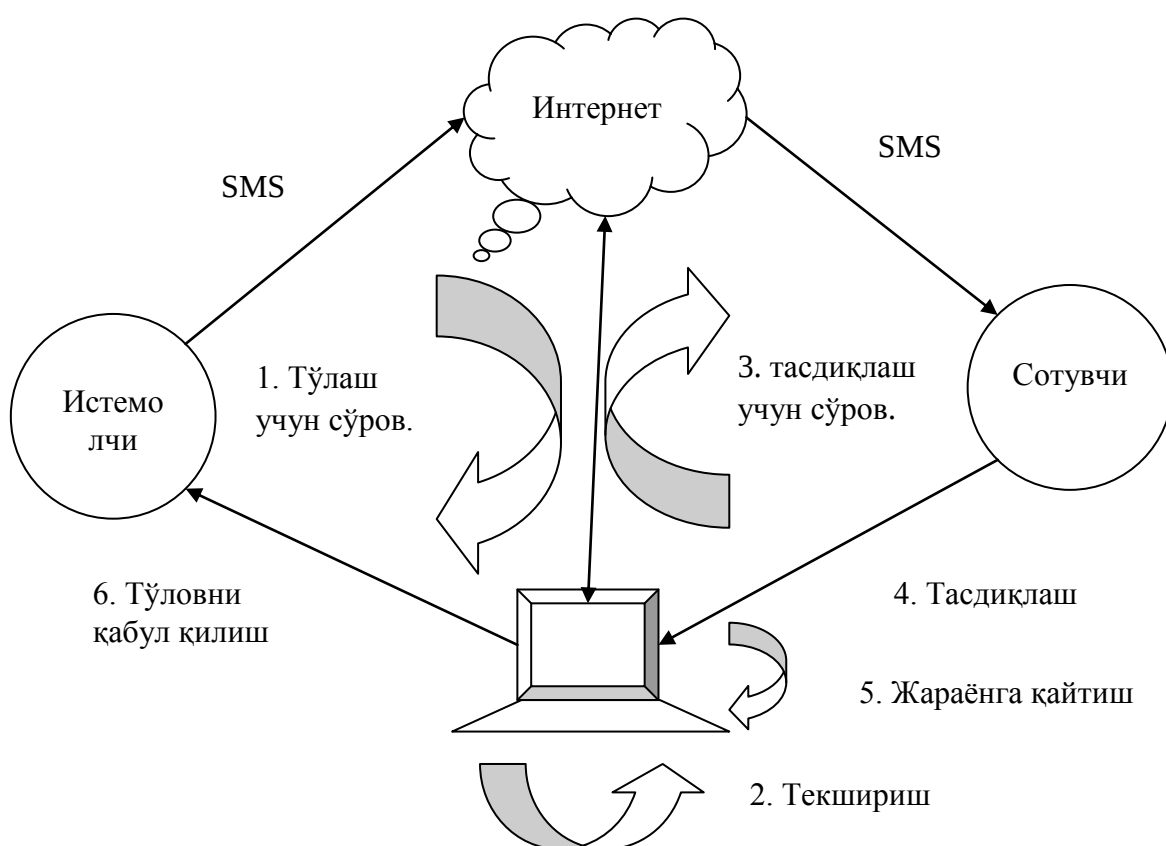
26-расм. Мобиль алоқа орқали тўлашнинг асос архитектураси
