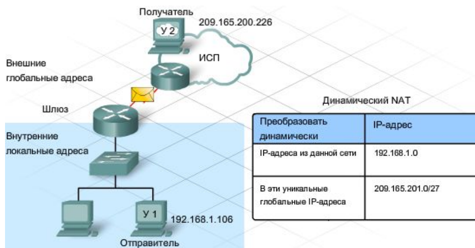
Рис. 9.8. Динамическое преобразование NAT
