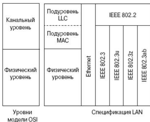
Рис. 4.2. Стандарт Ethernet и эталонная модель OSI
