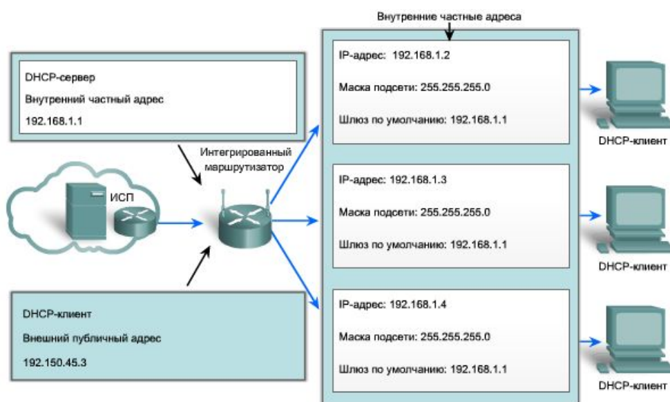
Рис. 3.52. Разграничение сети на локальную внутреннюю сеть и внешнюю сеть
