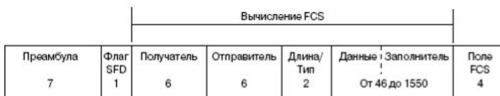
Рис. 4.4. Структура фрейма Ethernet спецификации IEEE 802.3
