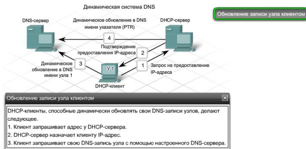
Рис. 9.23. Динамическая система DNS. Обновление записи узла клиентом
