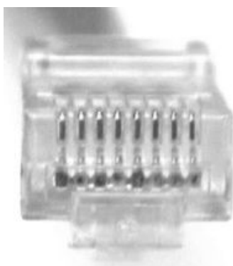
Рис. 2.29. Расположение контактов в разъеме RJ-45
