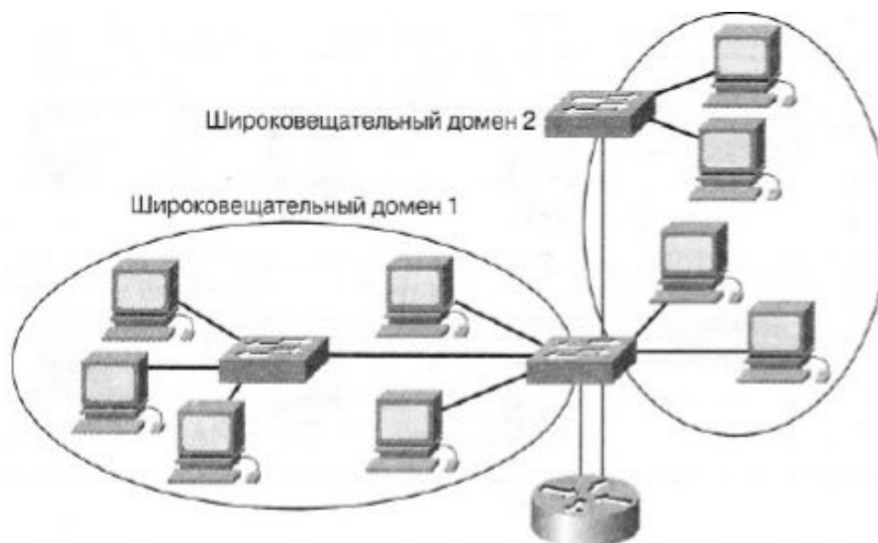
Рис. 6.8. Распределение широковещания в сети VLAN
