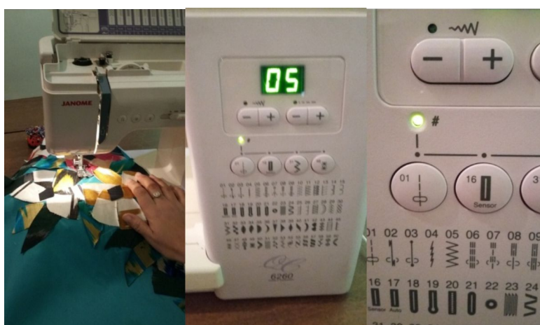
II-bob.23-rasm. Gullar yopishtirilganidan keyin tikuv mashinsining zig-zag choki yodamida 0,5sm kenglikda chetlari tikib chiqiladi.
