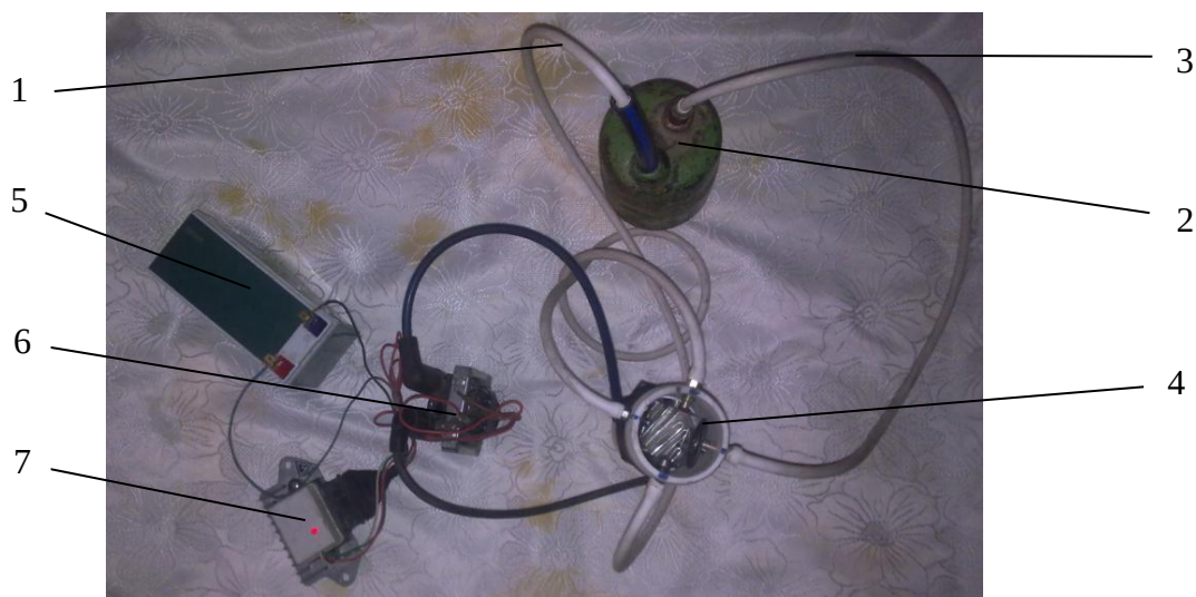
12- расм. Озон ва сув буғи аралашмасини хосил қилиш қурилмаси
