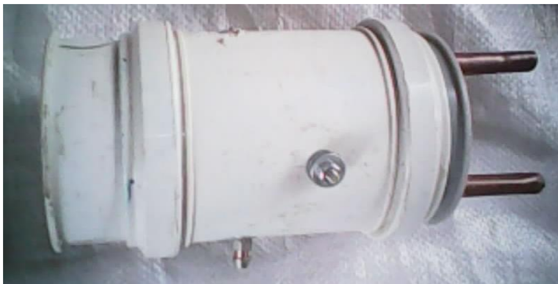
16- расм. Озон аралашмасини тайёрлаб ИЁДга узатувчи қурилма
