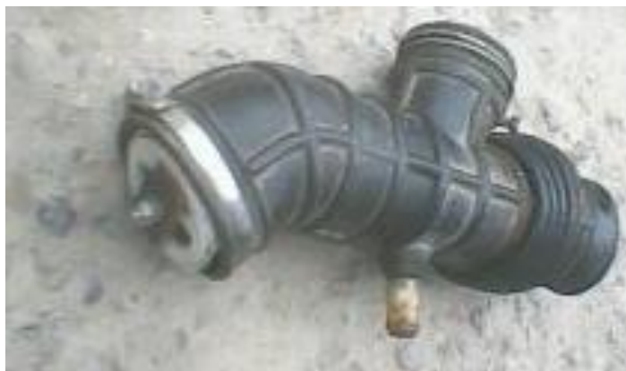
10-расм. «Нексия» автомобилнинг ҳаво шлангига ўрнатилган озонатор
