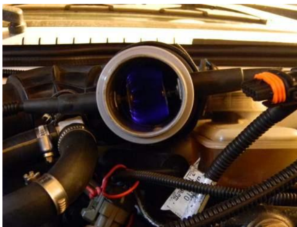
6- расм. В.Дудишевнинг автомобилга ўрнатилган буғ ва озон қурилмаси
