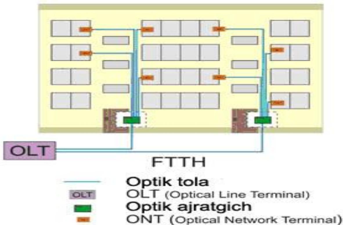
2-rasm. FTTH texnologiyasini tashkil qilish sxemasi
