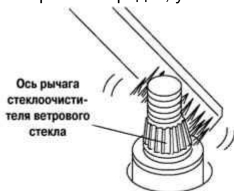
Рис. 7.58. Очистка шлицов осей рычагов стеклоочистителя
