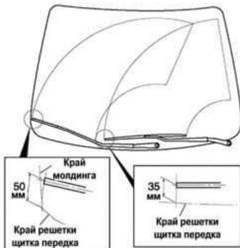
Рис. 7.59. Регулировка рычагов стеклоочистителя ветрового стекла со щетками
