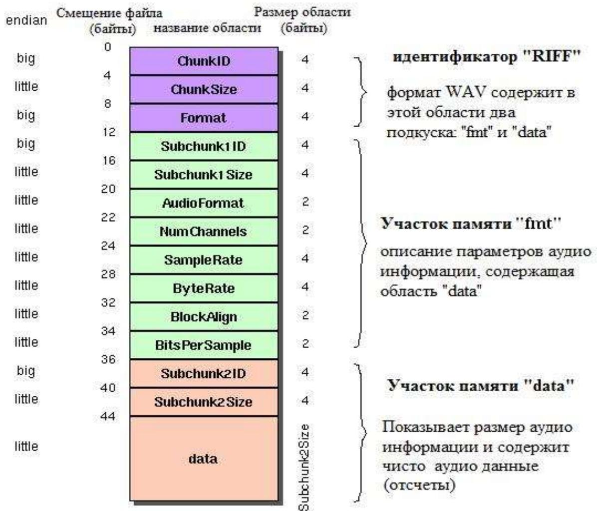
Рис. 1.1. Структура аудио файла WAVE типа RIFF.
