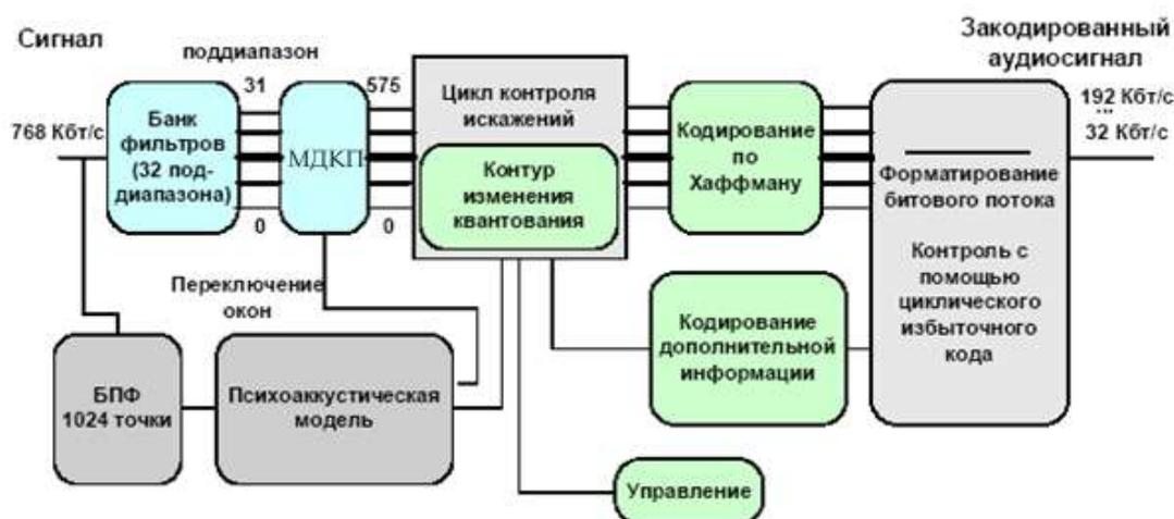
Рис. 1.2. Общая структурная схема кодера MP3
