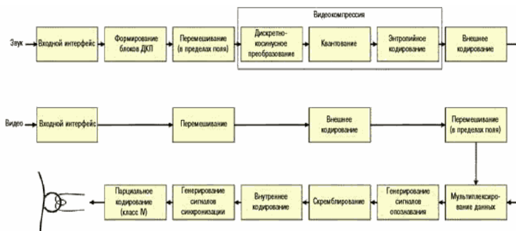
Рис.3.1. Структурная схема записи цифрового магнитофона Digital Betacam
