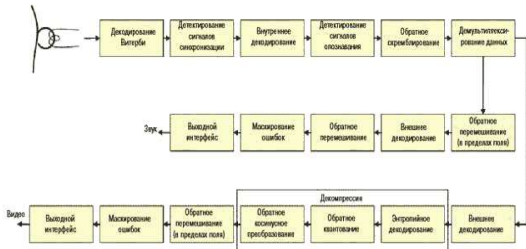
Рис.3.2. Структурная схема воспроизведения цифрового магнитофона Digital Betacam
