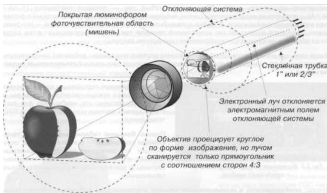
Рис. 1.2. Принцип работы передающей трубки
