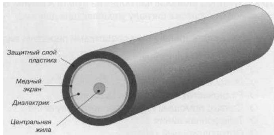
Рис. 1.21. Поперечное сечение коаксиального кабеля
