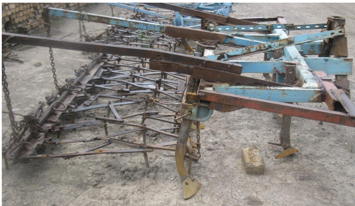
2.1.3-расм. Чизел – борана очик майдонларда ғалла экишдан олдин ерга ишлов беришда фойдаланилади
