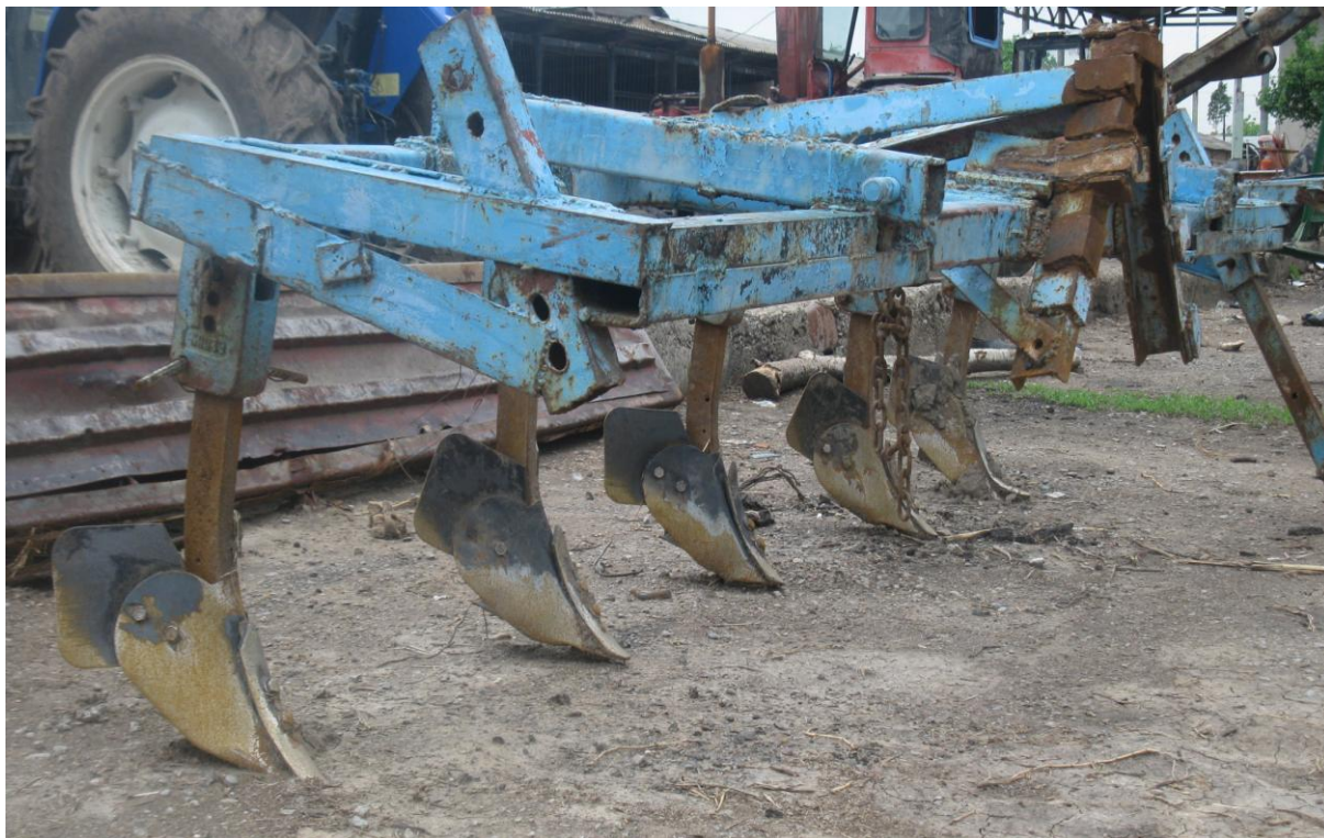
2.1.4-расм. 90 см ли эгат очгич. Бу эгат очкичдан очик майдонларга ғалла экилганда пушта(эгат) олиш мақсадида фермер хўжалигида фойдаланилади.
