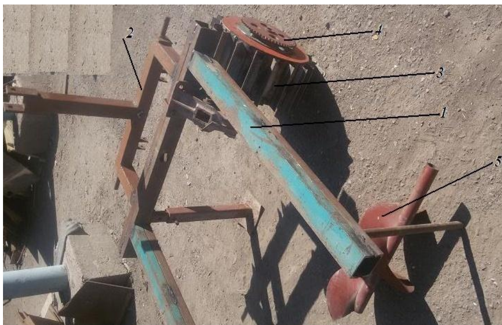
4.1 – расм. Агрегат тажриба вариантынинг устанд кўриниши 1-рама, 2-осма механизм, 3- тишли –илдирак, 4-етаковчи шестерня, 5-кўндаланг шнек.
