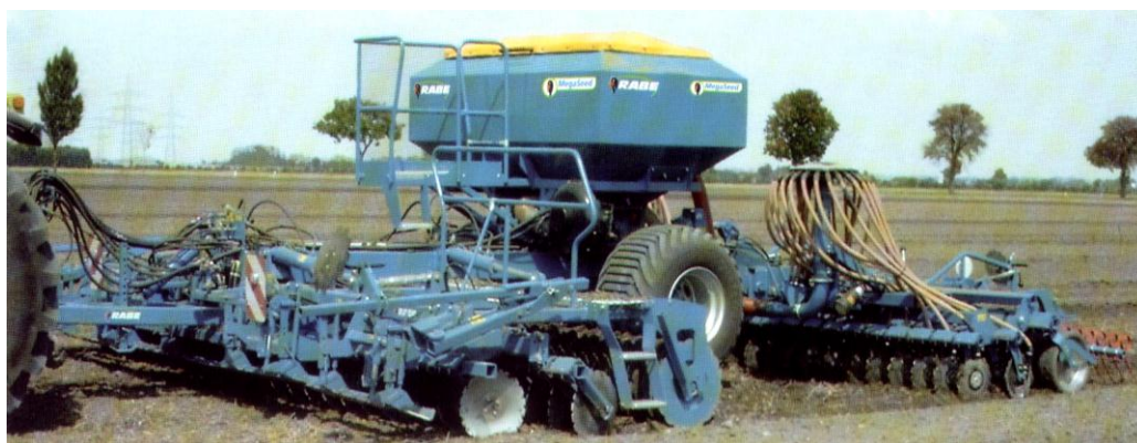
1.6-расм. Rabe фирмасининг тупроққа ишлов берувчи ва экувчи иш органлари билан жиҳозланган агрегати
