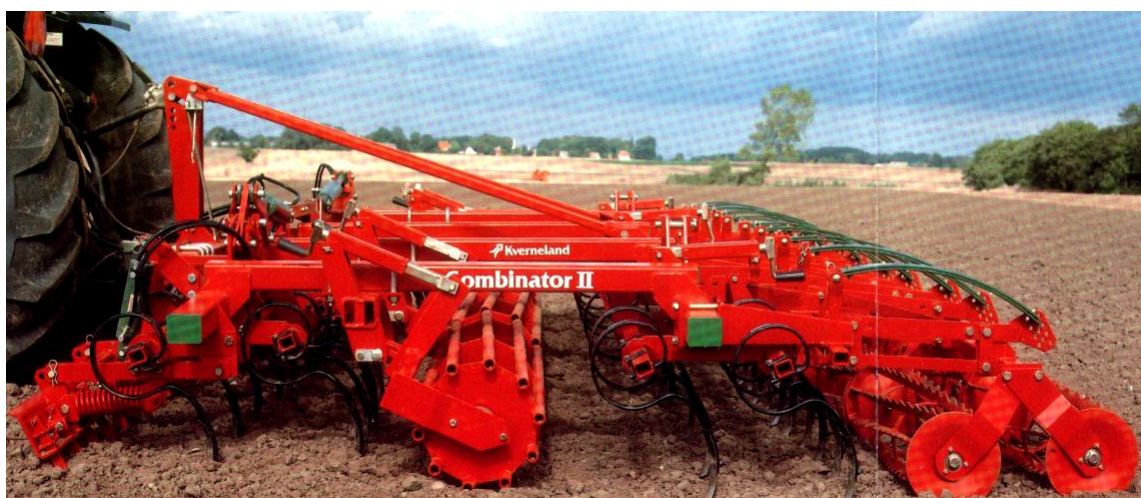
1.7-расм. Kverneland фирмасида ишлаб чиқариладиган комбинациялашган агрегат
