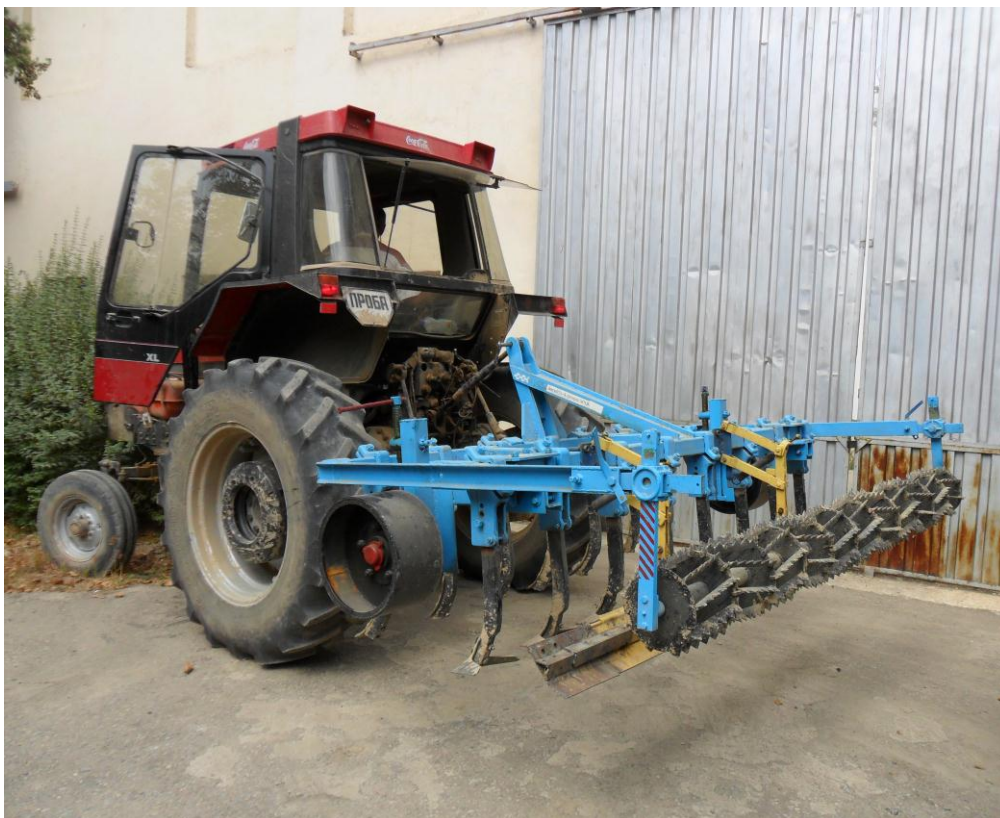
4.2-расм. Комбинациялашган агрегатнинг Кейс 4240Х тракторига осилган ҳолатдаги кўриниши
