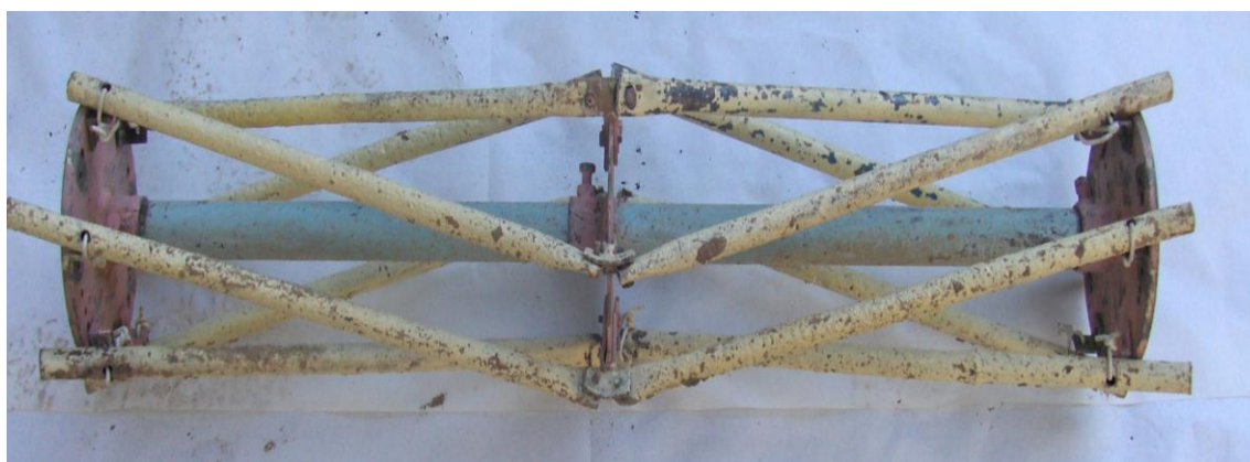
2.2-расм. Планкалы ( а ), тишли планкалы ( б ) ва прутокли ( в ) ғалтакмолалар
