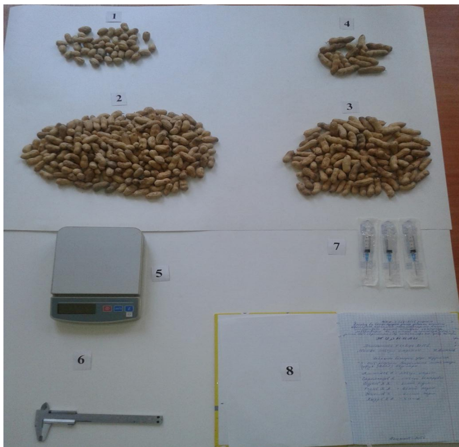
3.1-расм. Ерёнғоқ физик-механик хусусиятларини аниқлаш учун ишчи стол умумий кўриниши: 1, 2, 3, 4- бир, икки, уч ва тўрт дони бўлган ерёнғоқ мевалари, 5-электрон торози; 6-штангенциркуль; 7-шприц; 8-қайд этиш дафтари.
