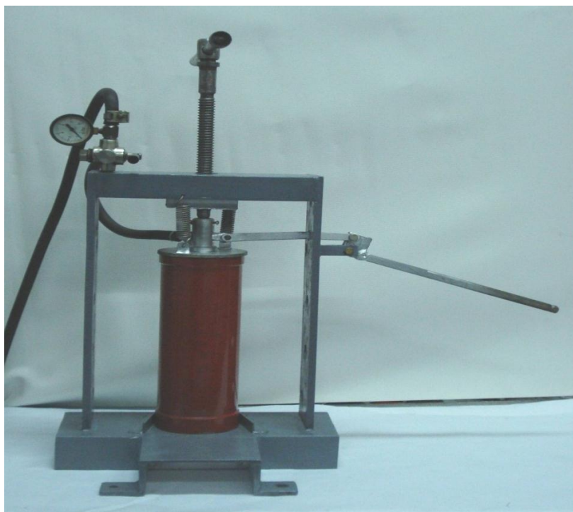
3.10-расм. Ер ёнғоқ қобиғини ажратиш қурилмаси намунаси умумий кўриниши.
