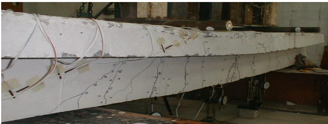
Рис. 2.1. Схема разрушения при срезе для контрольной балки ТТ1а
