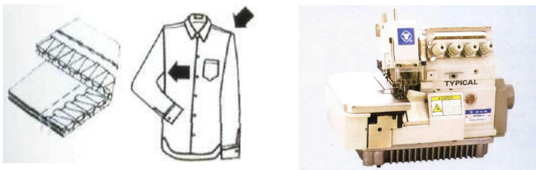
Rasm-6 besh ipli GH2000-5 rusumli yoʻrmlab tikuvchi mashina
