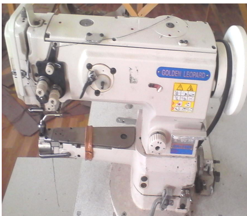
3.11-rasm. Sumka tutgichini tikuvchi "Golden leopard" maxsus tikuv mashinasi
