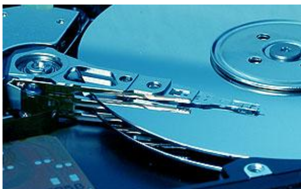
Расм 26. Винчестерда магнит усулда информацияни ёзиш ва ўқиш қурилмаси(головкаси).
