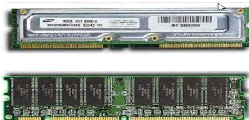
Расм 56. Хотира микросхемаси : RIMM(юқориси) ва DIMM(пасткиси).
