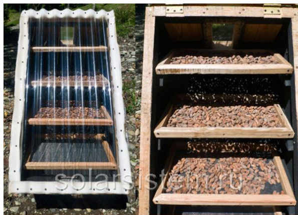
-расм: Мева сабзавотларни конвектив усулида қуритиш
