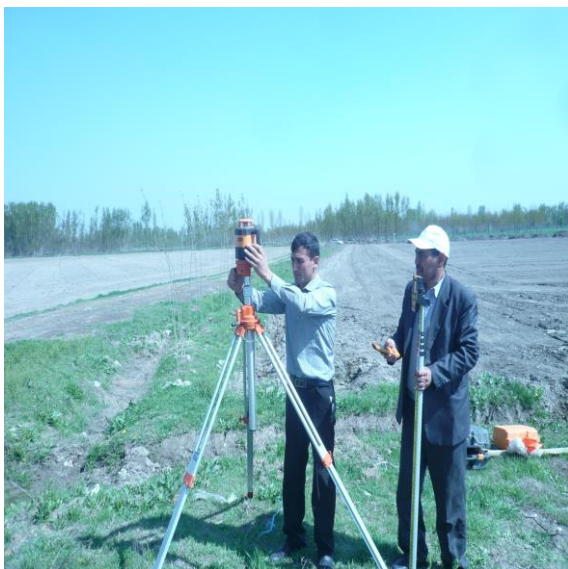
5-расм. Телескопик ўлчов линейка
