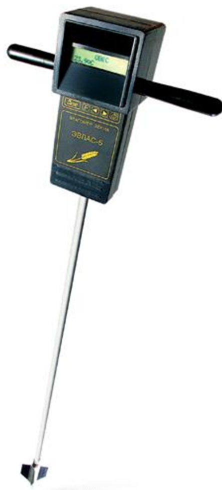
3 -расм. Дон намлигини аниқлайдиган замонавий электрон асбоблар
