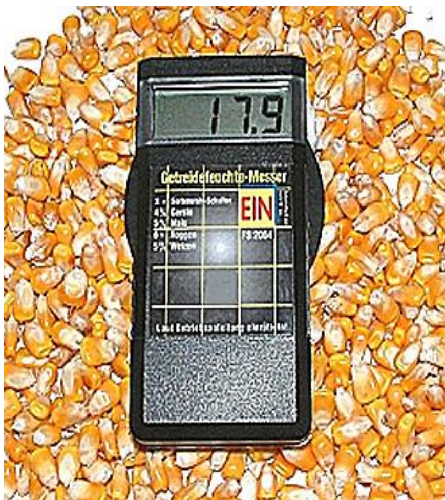
3 -расм. Дон намлигини аниқлайдиган замонавий электрон асбоблар
