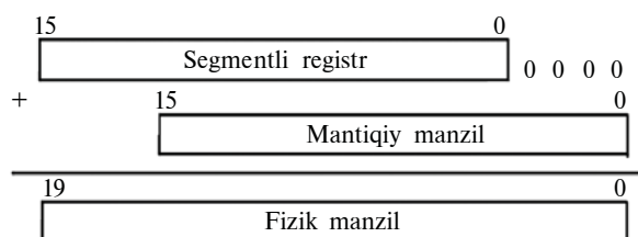
5.6-rasm. Fizik manzilni shakllantirish (i8086).
