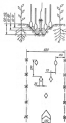
1.12-расм. Тупроқни юмшатиш учун қаторлар орасига ишчи органларни жойлаштириш намунавий схемаси
