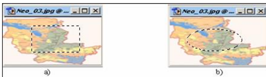
22-rasm. Maydonlarni belgilovchi uskunalar yordamida belgilash: a)To'g'ri to'rtburchak; b) Oval qismi.
