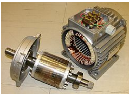
Рис.1. Ротор и статор асинхронной машины 0,75 кВт, 1420 об/мин, 50 Гц, 230—400 В, 3,4—2,0 А
