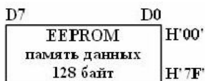
3.3-расм Энергияга боғлиқ бўлмаган EEPROM маълумотлар хотирасининг тузилиши
