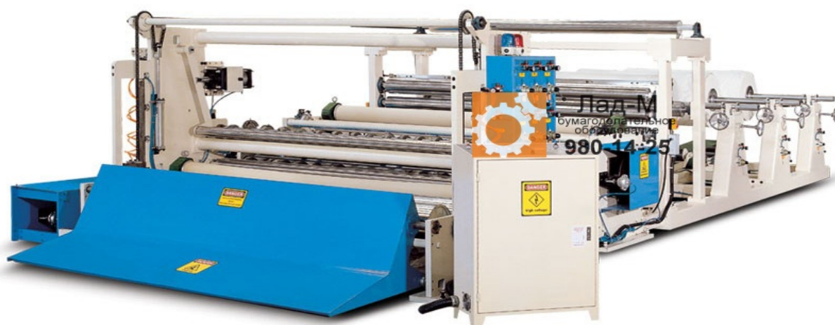
17-рasm. Қоғозни узунасиға қирқиш станокнинг умумий кўриниши
